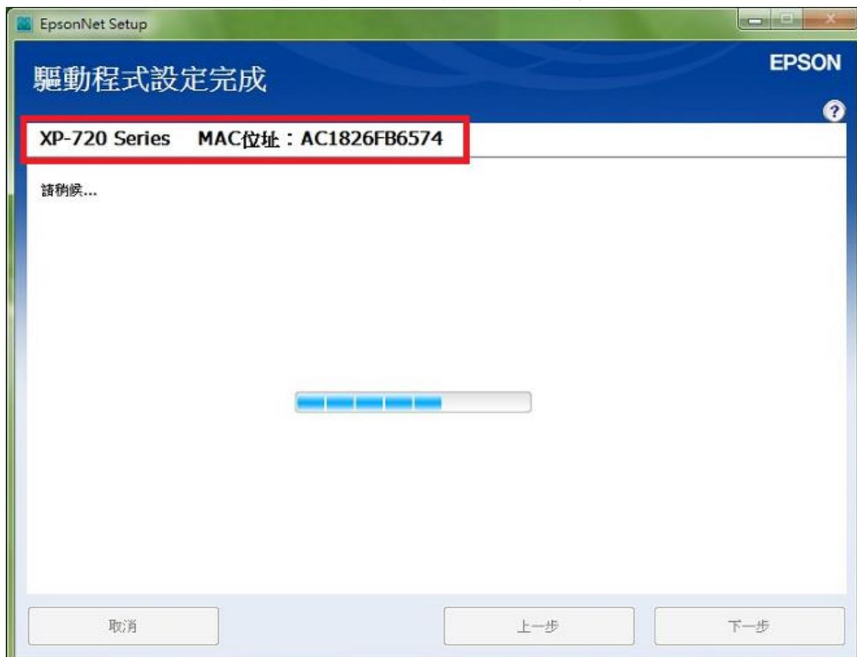
步驟 9、驅動設定完成後，畫面會出現「IP 位址設定」表示已抓到網路印表機並已設定完成，再按「下一步」。
