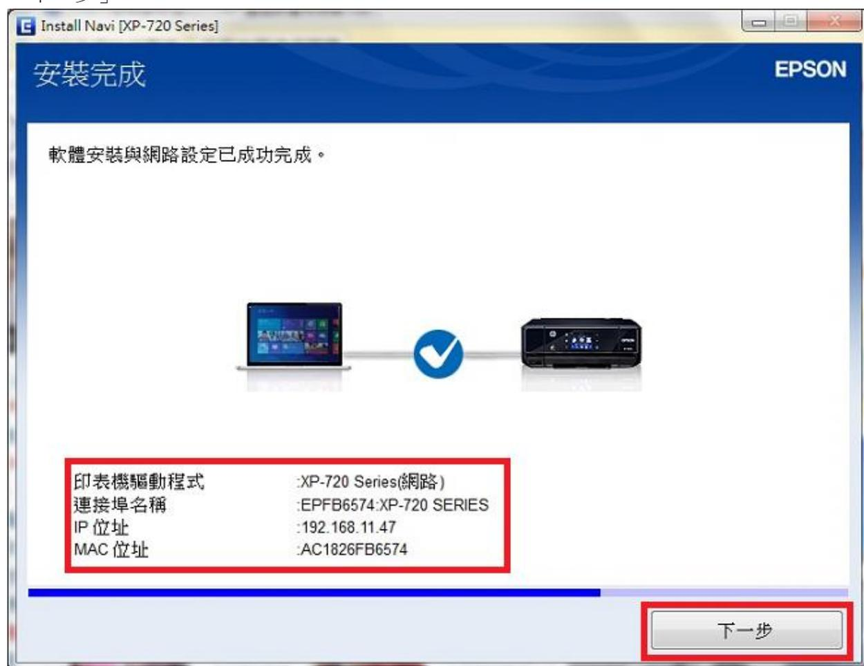
步驟 10、畫面安裝完成後，選擇「列印測試頁面」，確認有列印動作再選擇「下一步」。
